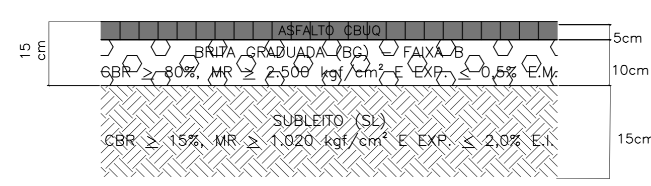
12 Detalhe asfalto CBUQ
